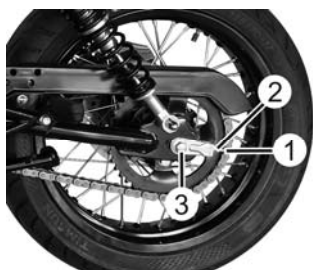
①调节螺栓 ②锁定螺母 ③后轮主轴螺帽
